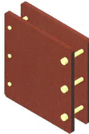
Fig. 2 Insulation film of cell clamp 图 2 电池夹具包绝缘膜示意图
