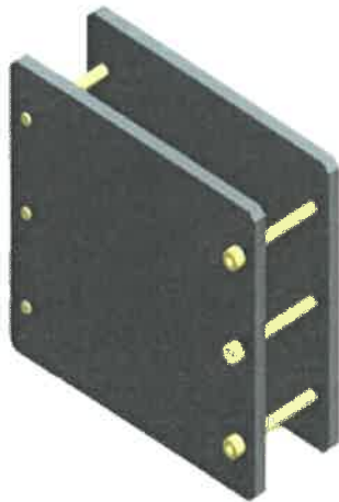
Fig. 1 Schematic diagram of cell clamp 图 1 电池夹具示意图
